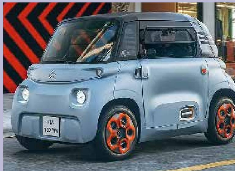
est conçue. Nichée dans son esthétique rétro se trouve une puissance familière, identique à la Citroën Ami : un moteur de 6 kW, une batterie de 5,5 kWh, une vitesse maximale de 45 km/h et une autonomie louable de 75 km réalisable après seulement 4 heures de charge. Les deux variantes, Citroën et Fiat, sont proposées avec une étiquette de prix
